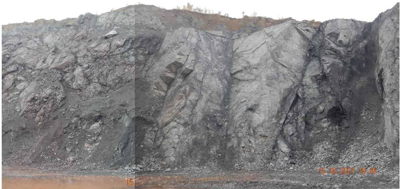
Abbildung 2: Blick auf den westlichen Abschnitt des südlichen Böschungssystems auf der 4. Sohle. Die neu aufgeschlossenen, großflächig ausgebildeten und geneigt einfallenden Trennflächen fallen zumeist in Richtung Nordosten bzw. Nordwesten ein und verschneiden sich keilförmig.
