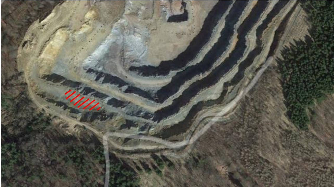
Abbildung 1: Digitales Orthophoto (DOP) vom September 2020 [U 7]. Der spätere Rutschungsbereich zeichnet sich im Luftbild durch schwach erkennbare Schatten ab. Die betroffene Fläche ist rot schraffiert dargestellt.
