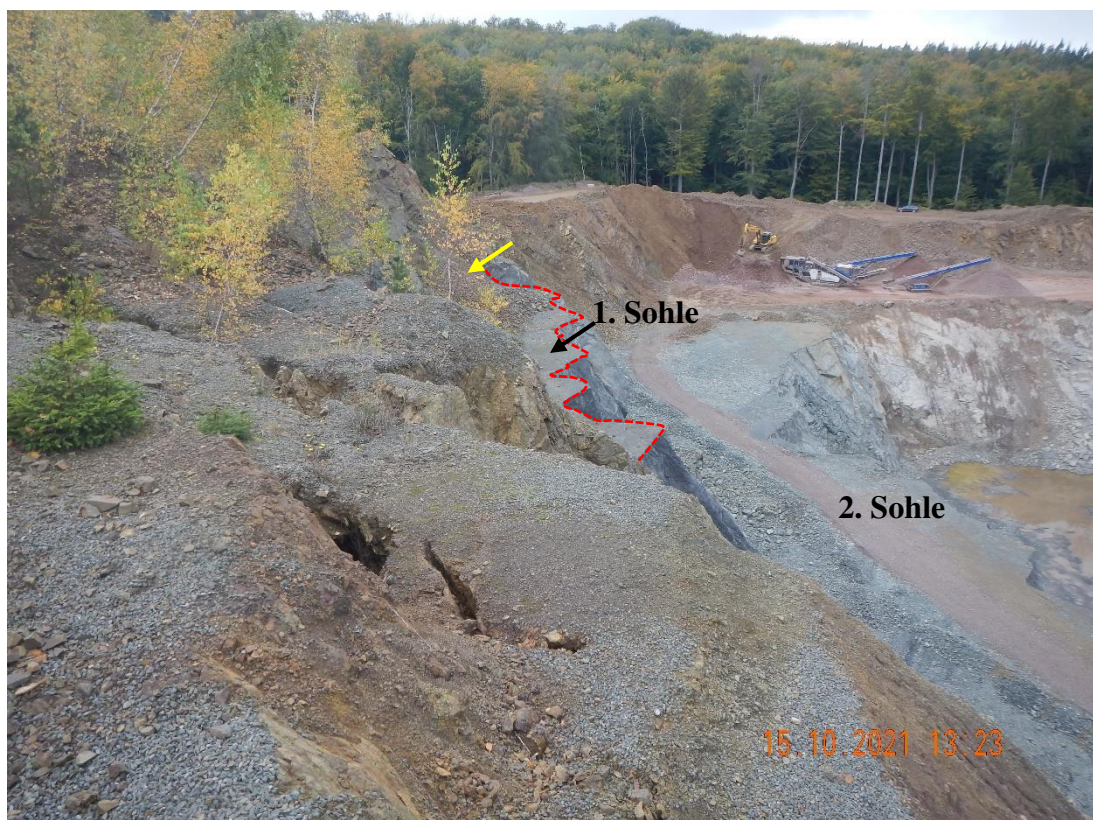
Abbildung 14: Blick nach Westen auf die gezackten (vermutlich sukzessive verbrochenen) Konturen der 1. Sohle des südlichen Böschungssystems (rot gestrichelt gekennzeichnet). Der gelbe Pfeil verweist auf überrollte Abschnitte entlang der 1. Sohle. Im Hintergrund ist die mobile Aufbereitung auf der 2. Sohle (südlicher Bereich der Westböschung) zu sehen.
