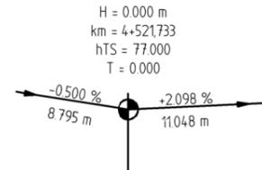
Neigungsbrechpunkte mit Angaben von Ausrundungshalbmesser, Längsneigung und Abstand zum nächsten Neigungsbrechpunkt
